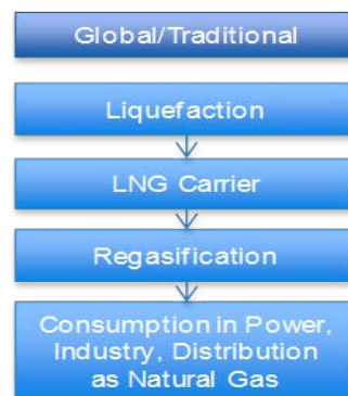
Figure 3 - The LNG Value Chain for Globally Traded LNG
